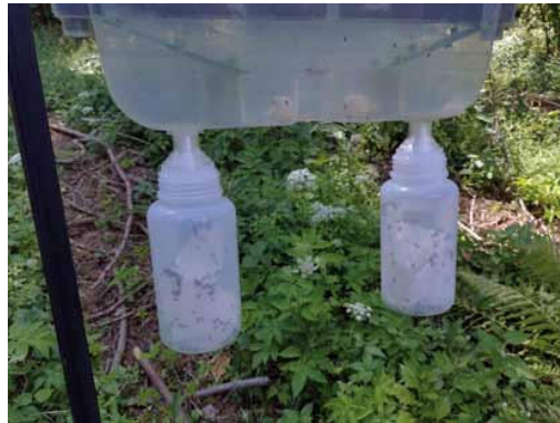
Obrázok 4. Upravená odchytovej nádoba lapača s nosičmi entomopatogénnej huby a odchytovejmi fľašami Figure 4. Modified collection tray with carriers of entomopathogenic fungus, and trapping bottles.
